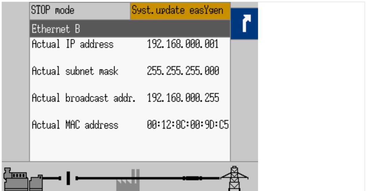
Fig. 365: Ethernet Network B screen
