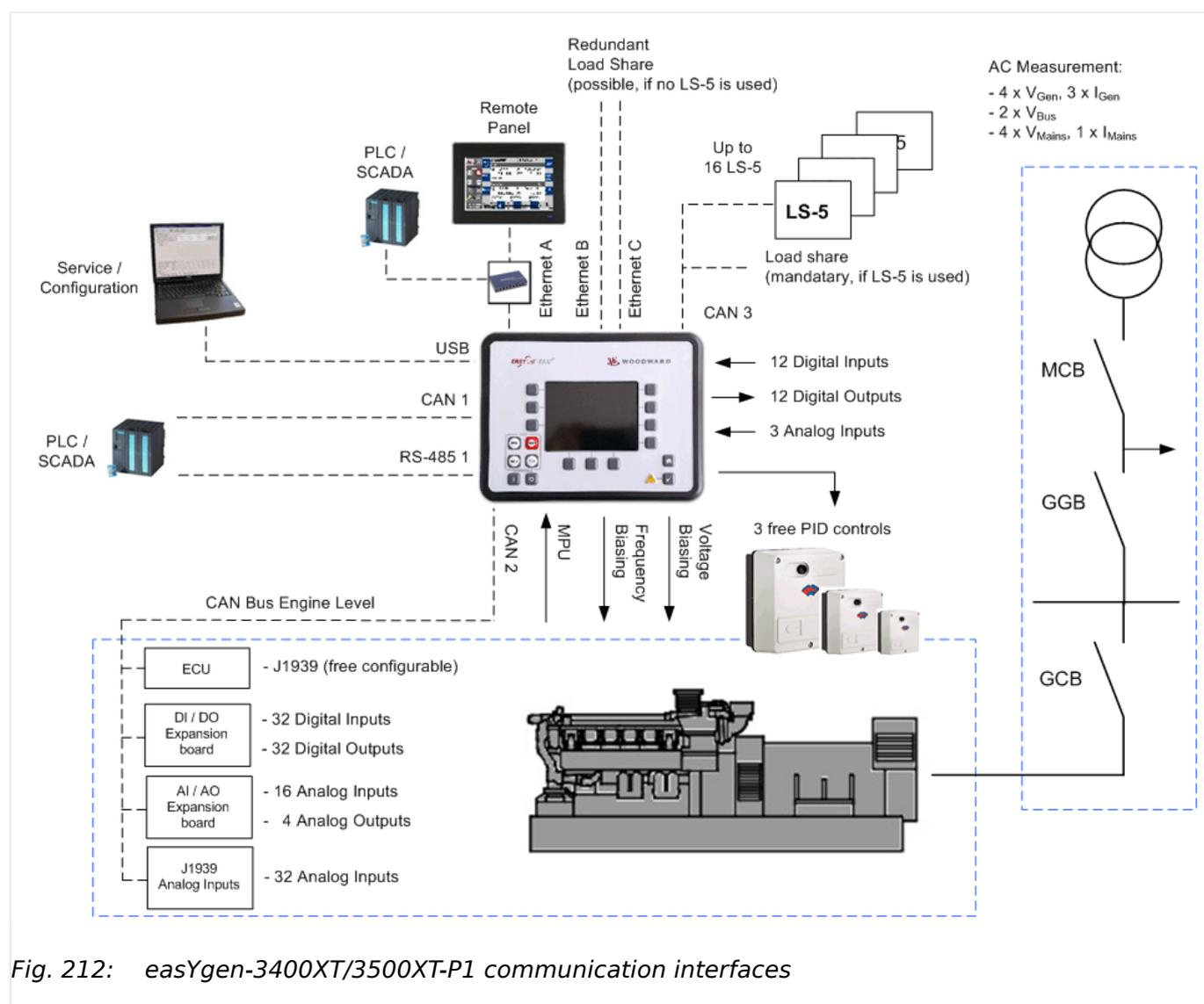
Fig. 212: easYgen-3400XT/3500XT-P1 communication interfaces
