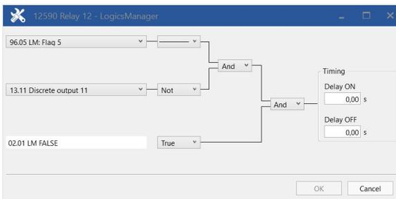
Fig. 253: LogicsManager function "Relay 12"
