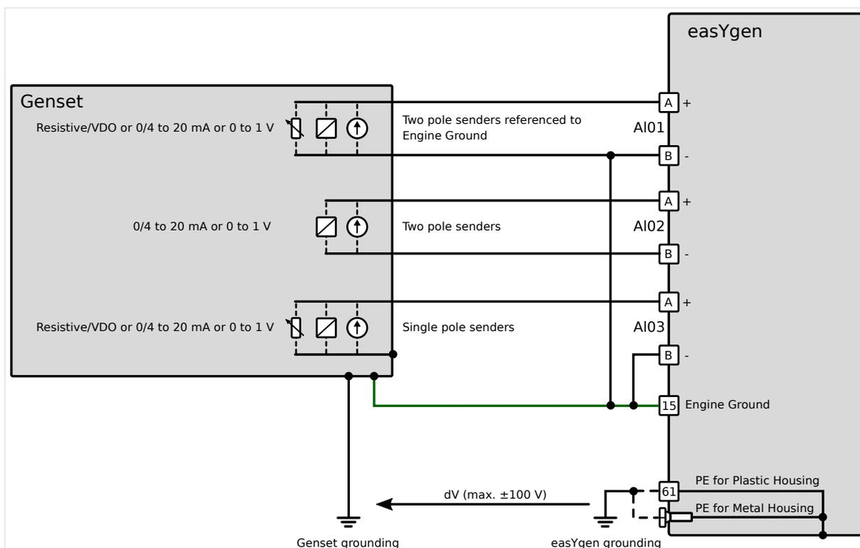
Fig. 70: Analog inputs - wiring senders
