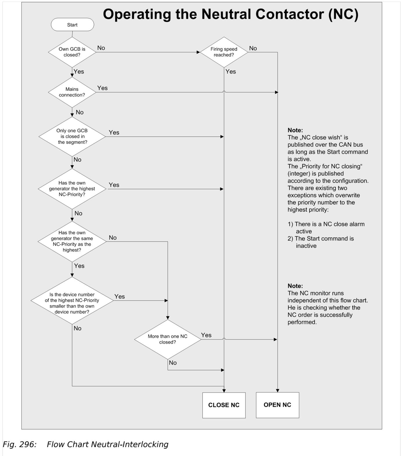
Fig. 296: Flow Chart Neutral-Interlocking
