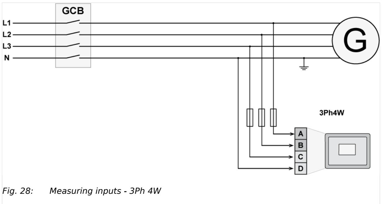
Fig. 28: Measuring inputs - 3Ph 4W
