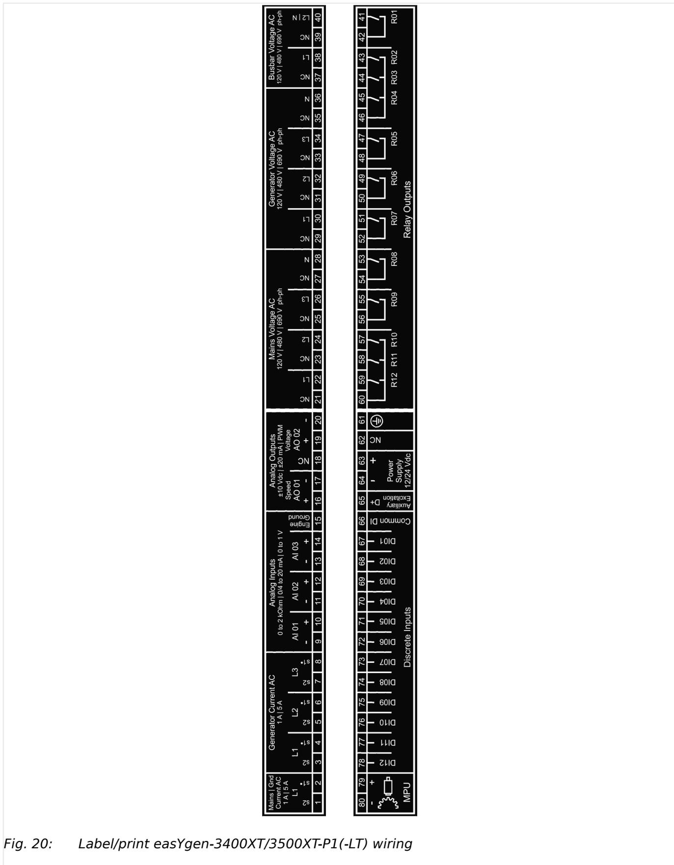
Fig. 20: Label/print easYgen-3400XT/3500XT-P1(-LT) wiring
