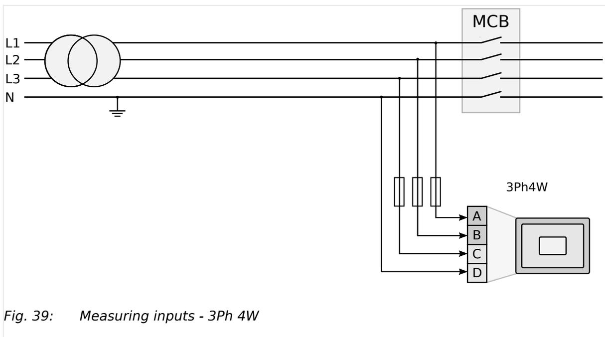
Fig. 39: Measuring inputs - 3Ph 4W
