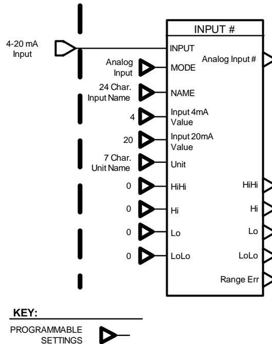
Figure 3-9. Analog Input Example
