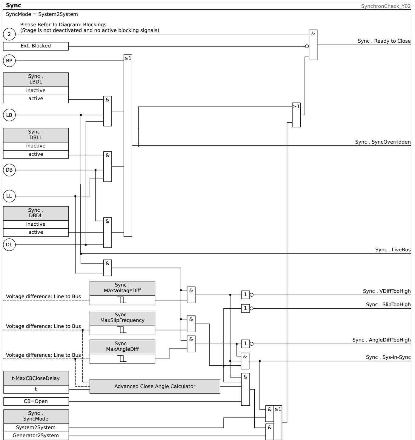
Fig. 55: Functionality of the »Sync« module, "System2System".
