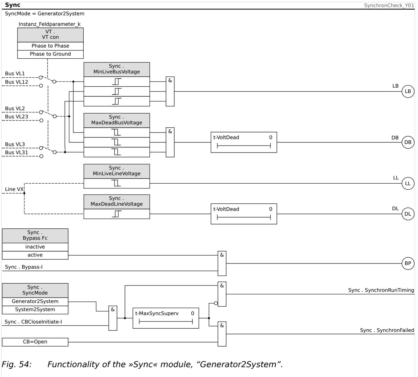
Fig. 54: Functionality of the »Sync« module, "Generator2System".
